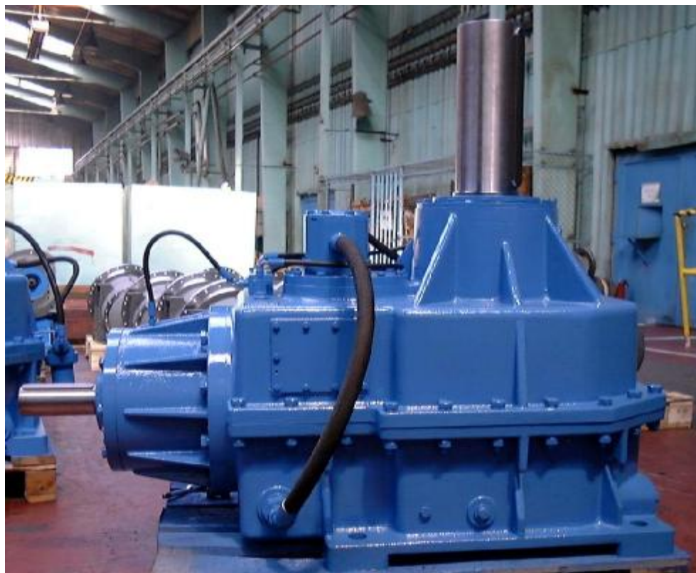
Prevodovka KCV12, elektrárň, Násiríja, Irak.
